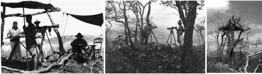
Cartografia: levantamento com alidade e prancheta
