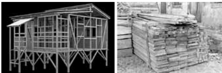
Fig. 017 - Modelo tridimensional de habitação e fotografia de materiais para a construção de uma casa, tipo “kit”.
