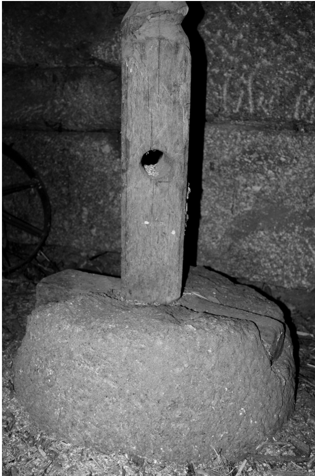
Fig. 9 – Ligação do peso ao fuso por sistema de duplo chanfro
