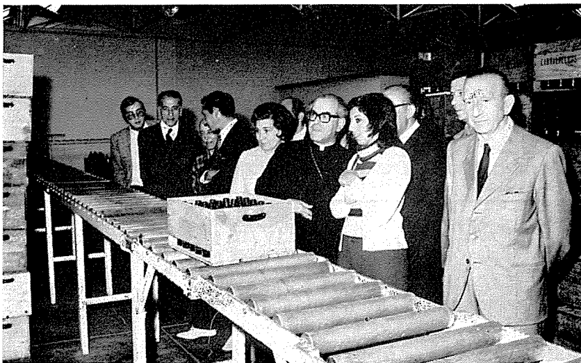
Fig. 11 — Tapete rolante para o transporte do vasilhame pelas diferentes secções do engarrafamento da Água de Carvalhos
