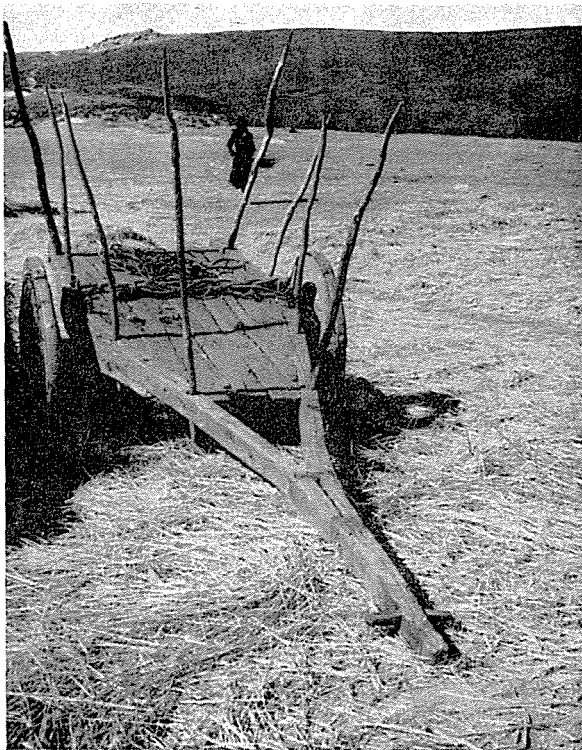
Fig. 61 — Carro de bois com altos fueiros ou estadulhos, para permitirem carga alta: a corda no estrado para amarrar com solidez a carga.
